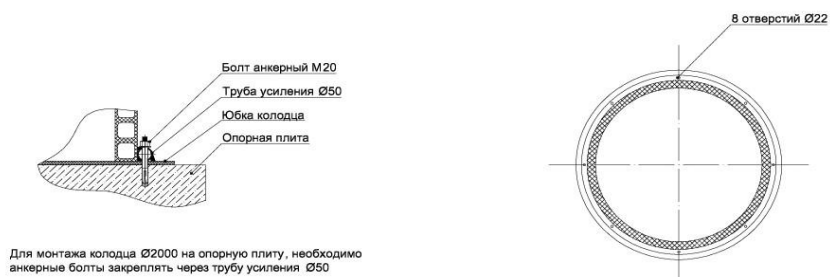
Рис. 3. Схема установки и крепления колодца к ж/б основанию.
